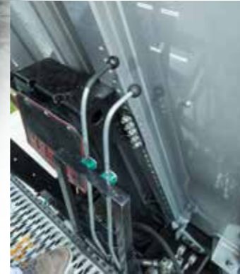
Die Bedienung mit zwei Hydraulikventilen ist sehr einfach. Fehlbedienungen sind so gut wie ausgeschlossen.
