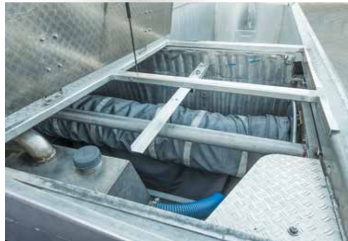
Aufgewickelt wird der GÜllesack platzsparend im vorderen Teil der Mulde untergebracht. Etwa 5 m 3 Ladevolumen nimmt die GÜlletechnik in Anspruch.
