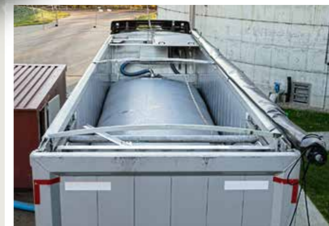
Der Gülledruck treibt das Abwickeln des Gülleschlauchs. Vollgepumpt schmiegt sich die Membran der Muldeninnenwand an und fasst bei dieser Kempf-Mulde 28 m 3 .
