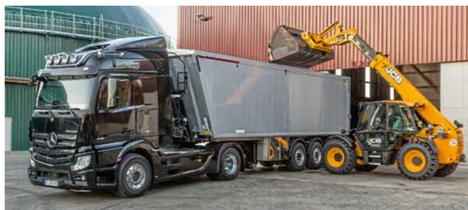
Die Mulde kann ohne Weiteres mit festen Stoffen beladen werden. Der Kippwinkel beträgt 51°.
