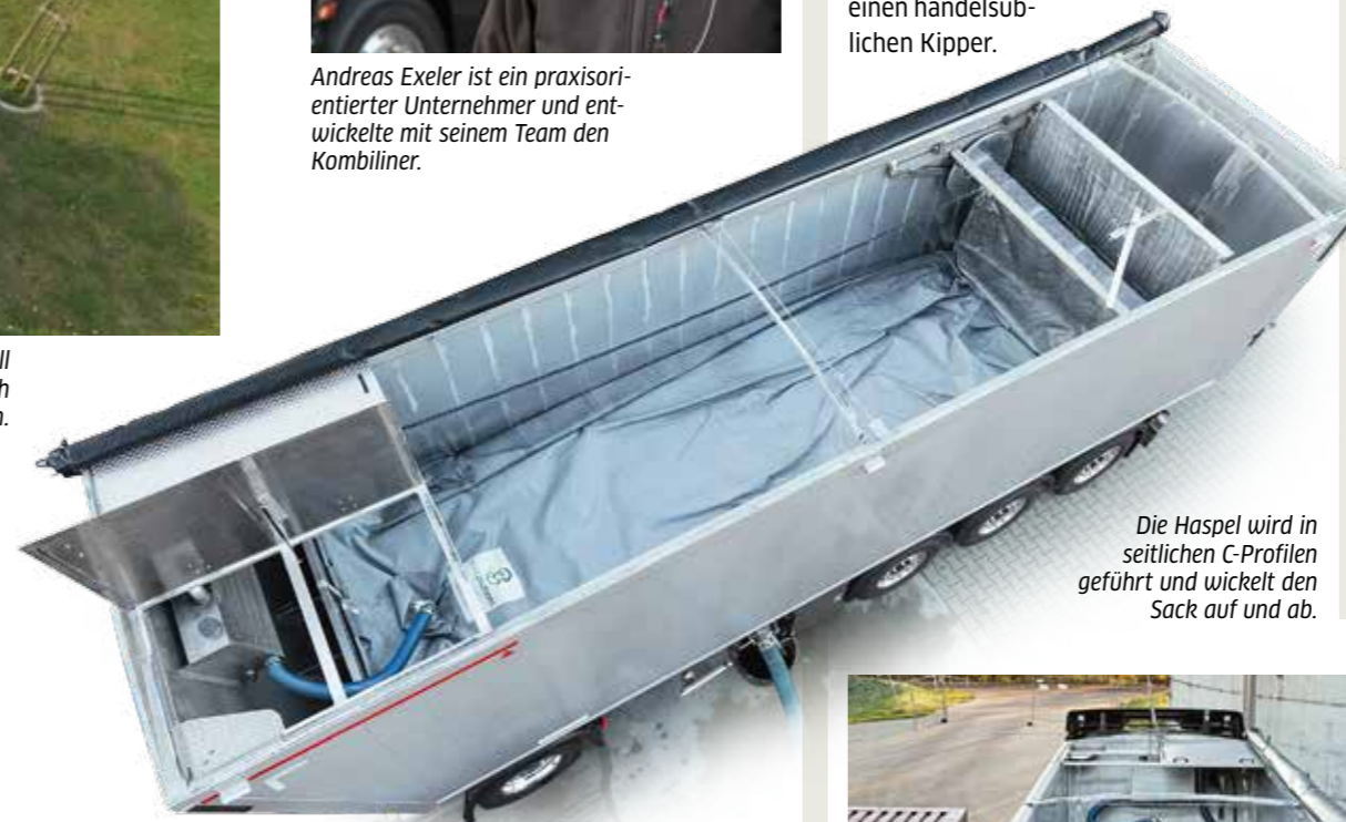
Muldenkipper voll Gülle. Der Schlauch macht es möglich.
