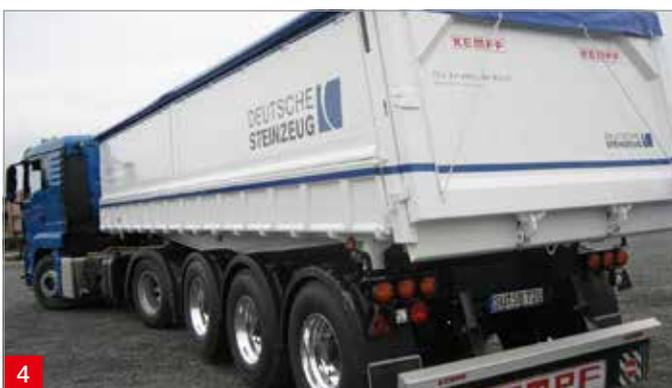
**[1]+[5]** SK 35/3-S, 7900 x 2400 x 1700 mm, ca. 33 m<sup>3</sup>, Boden 7 mm Alu, B.W. Alu 40 mm, pneumatischer Schüttgutabweiser aus Stahl 400 mm breit, Eigengewicht ca. 5850 kg
