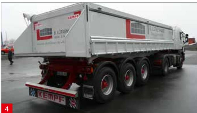
**[1]+[2]** SKD 32/2-P, 7500 x 2450 x 1100 mm, ca. 21 m<sup>3</sup>, Fahrgestellrahmen in Kastenbauweise, Boden 7 mm Alu, B.W. Alu 40/30 mm, Eigengewicht ca. 5200 kg
