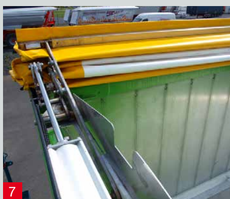
[4] hydraulische Schütte, 400 mm hoch, 120° Öffnungswinkel, pneumatisch angesteuert
