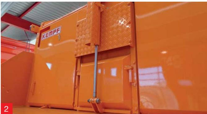
[4] Hinterer Bordmatikzylinder geschützt in der Eckrunge eingebaut. Schnellösevorrichtung für die Seile des elektrischen Verdeckes.
