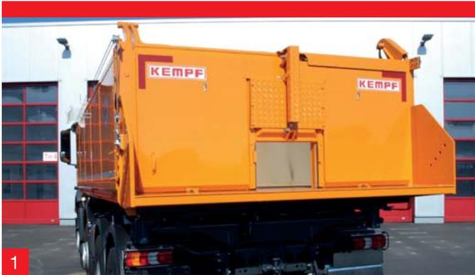
[1]+[2] Hydraulischer Asphaltschieber (isoliert) 400 x 400 mm, Betätigung über Kabelfernbedienung oder über Funk. Steuerung über ein separates elektrohydraulisches Pumpenaggregat.
