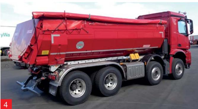
[1]+[2] KAM 35-SRi, 5200 x 2350 x 1350 mm, Boden 5 mm HB 450, B. W. 4 mm HB 450, Eigengewicht ca. 3700 kg
