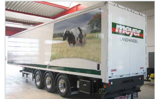
Pritschen-Sattelaufleger mit Schiebeboden. Innenwandung 2,8 mm. Rückwand als doppelflügelige Türe. Mit Schiebewand, mit Schleuse. Ladevolumen 70 m 3 . Eigengewicht ca. 7.380 kg.
