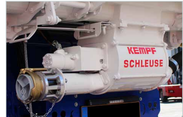
Hochleistungs-Zellenradschleuse nach UVV-Richtlinien, mit Not-Aus und Nahrungsschalter. Schleuse für den Transport von Mischfutter, Getreide und Dünger geeignet.
