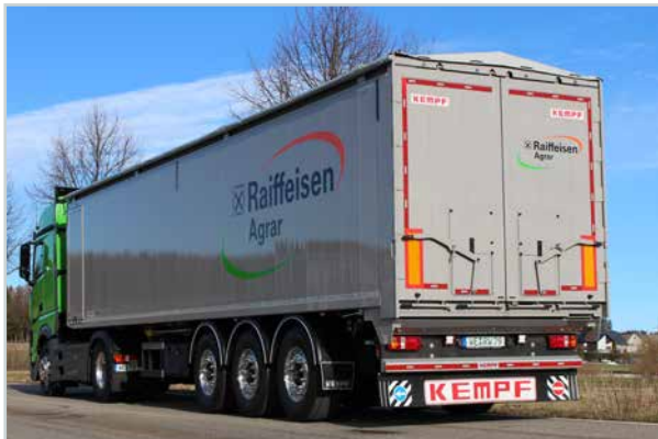
Pritschen-Sattelaufleger mit Schiebeboden. Innenwandung 2,8 mm mit Tür. Rückwand als 2-flüglige, Tür und Schieber. Mit Schiebewand. Ladevolumen 62,5 m 3 . Eigengewicht ca. 6.700 kg.
