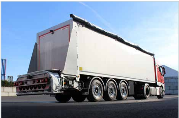
Pritschen-Sattelaufleger mit Schiebeboden. Innenwandung 2,8 mm. Hydraulische Rückwand. Mit mitlaufender Wand und Treberpresse. Ladevolumen 51 m 3 . Eigengewicht ca. 8.020 kg.
