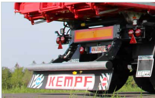
Unterfahrschutz nach ECE R58.03
