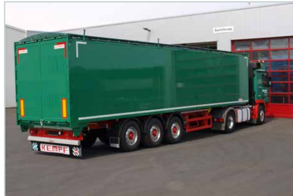
Pritschen-Sattelaufleger mit Schiebeboden. Innenwandung 2,8 mm bzw. 4,5 mm hinten. Rückwand als 2-flüglige Tür. Mit Schiebewand und Bodenplane. Ladevolumen 69,4 m 3 . Eigengewicht ca. 7.240 kg.
