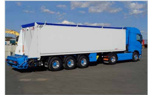
Pritschen-Sattelaufleger mit Schiebeboden. Innenwandung 2,8 mm. Hydraulische Rückwand. Mit mitlaufender Wand und Treberpresse. Ladevolumen 49 m 3 . Eigengewicht ca. 8.300 kg.
