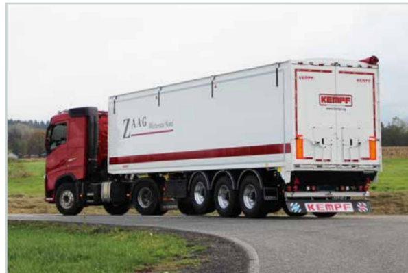
Pritschen-Sattelaufleger mit Schiebeboden. Innenwandung 2,8 mm. Rückwand als 2-flüglige Tür mit Schieber. Mit Schiebewand. Ladevolumen 59 m 3 . Eigengewicht ca. 6.280 kg.
