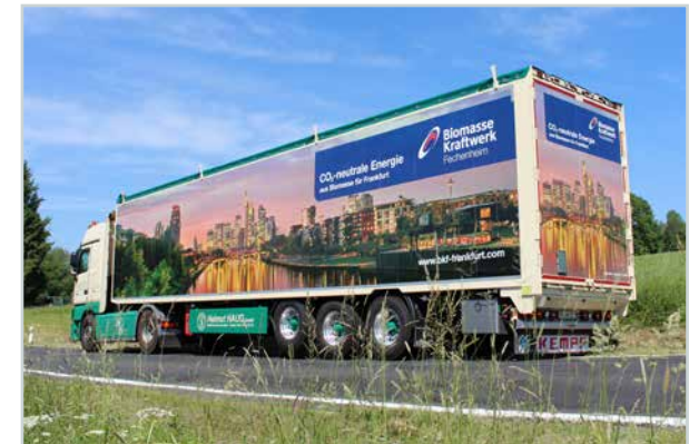
Pritschen-Sattelaufleger mit Schiebeboden. Innenwandung 2,8 mm. Rückwand als 2-flüglige Tür. Mit Schiebewand. Ladevolumen 91 m 3 . Eigengewicht ca. 7.900 kg.
