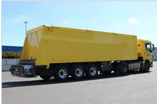
Pritschen-Sattelaufleger mit Schiebeboden. Innenwandung 2,8 mm. Hydraulische Rückwand. Mit mitlaufender Wand und Treberpresse. Ladevolumen 49 m 3 . Eigengewicht ca. 7.840 kg.
