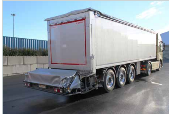
Pritschen-Sattelaufleger mit Schiebeboden. Innenwandung 2,8 mm. Hydraulische Rückwand. Mit mitlaufender Wand und Treberpresse. Ladevolumen 49 m 3 . Eigengewicht ca. 8.300 kg.
