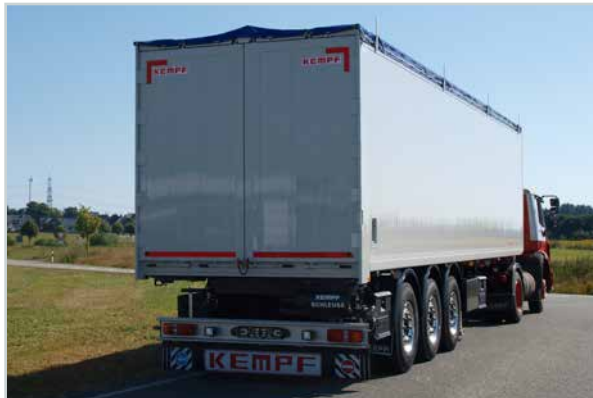
Pritschen-Sattelaufleger mit Schiebeboden. Innenwandung 2,8 mm. Hydraulische Rückwand. Mit Schiebewand, mit Schleuse und Trichter. Ladevolumen 62,2 m 3 . Eigengewicht ca. 6.940 kg.
