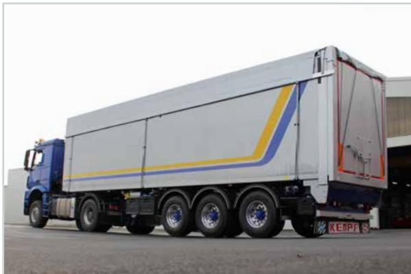
Pritschen-Sattelaufleger mit Schiebeboden. Innenwandung 3 mm bzw. 4,5 mm hinten. Rückwand hydraulisch aufstellbar, mit Schieber und Trichter. Ladevolumen 62 m 3 . Eigengewicht ca. 7.180 kg.
