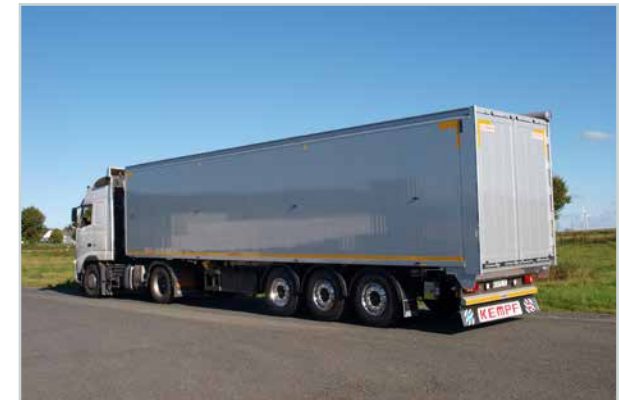
Pritschen-Sattelaufleger mit Schiebeboden. Innenwandung 2,8 mm. Rückwand als 2-flüglige Tür. Mit Schiebewand. Ladevolumen 67,8 m 3 . Eigengewicht ca. 6.520 kg.
